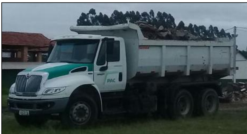
Figura 71. Caminhão responsável pela coleta dos RCC de Canas (SP).
